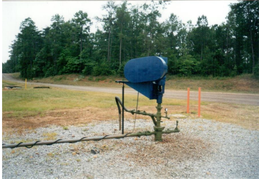
Рисунок 1.2 – Свердловина, яка пробурена на гірничі виробки вугільної шахти родовища Блек Воррієр (США) для відведення метану з одночасною відкачкою води кавітаційним насосом [ https://houseand.ru/tool/the-design-operation-principle-and-purpose-of-the-rocking-machine-oil-rocking-chair/ ]
