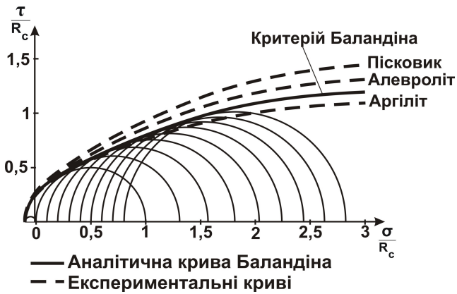
Рис. 6. Огинаючі кругів Мора, побудовані за аналітичними виразами і експериментальними даними
