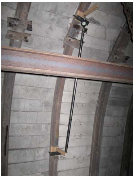
Рис. 4.10. Замерная станция в условиях ш. «Степная» ПАО «ДТЕК Павлоградуголь»
