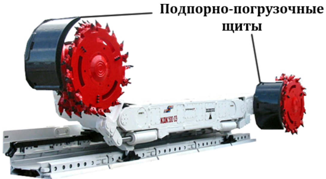
Рис. 3.10. Расположение подпорно-погрузочного щита на комбайне КДК-500-03
