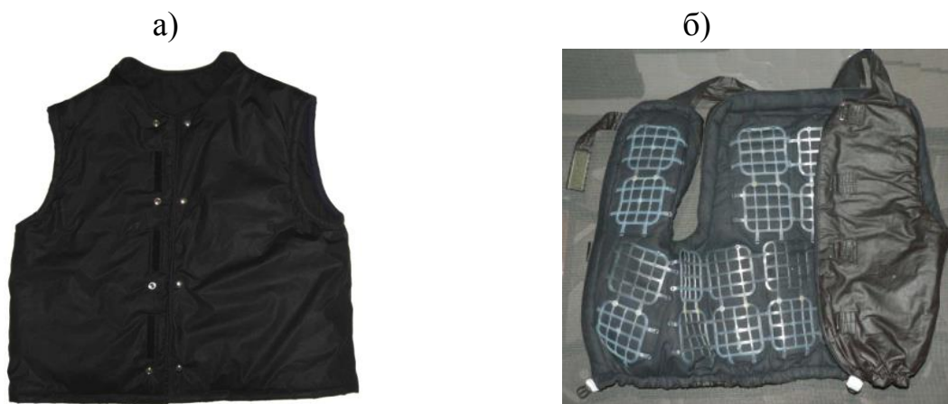
Рисунок 9.1. Охлаждающий жилет горнорабочих (ОЖГ): а – внешний вид; б – в развёрнутом виде с карманами для охлаждающих элементов (ОЭ)
