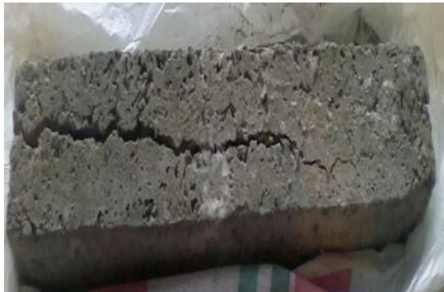
Рис. 1.19. Наскрізні тріщини в бетонному зразку, зумовлені заморожуванням води, яка знаходиться всередині порожнини
