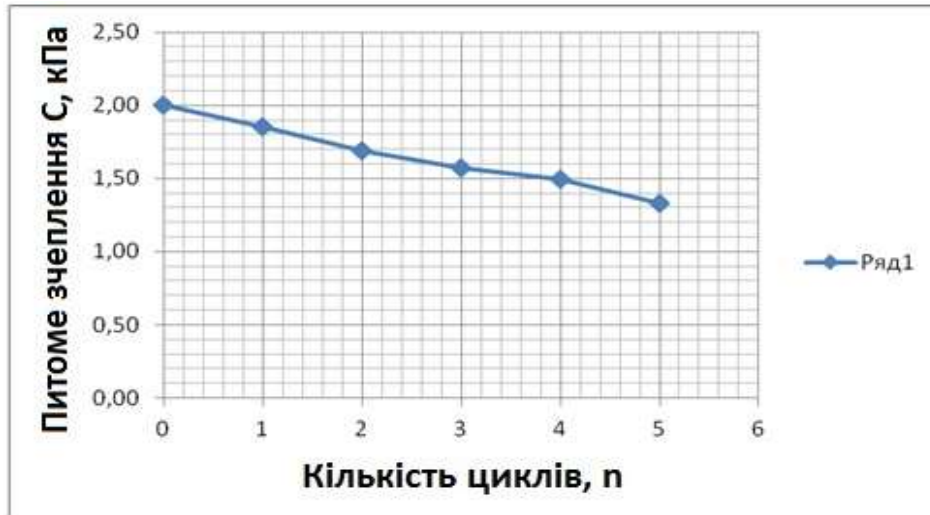
Рис. 1.11. Залежність питомого зчеплення піску від кількості циклів «заморожування – розморожування»
