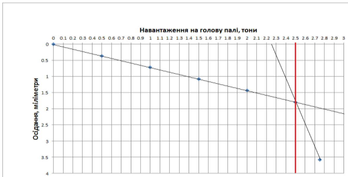
Рис. 3.8. Результати визначення несучої здатності палі після першого циклу замерзання - відтаювання основи. F_{d,1} = 2,50 тонни.
