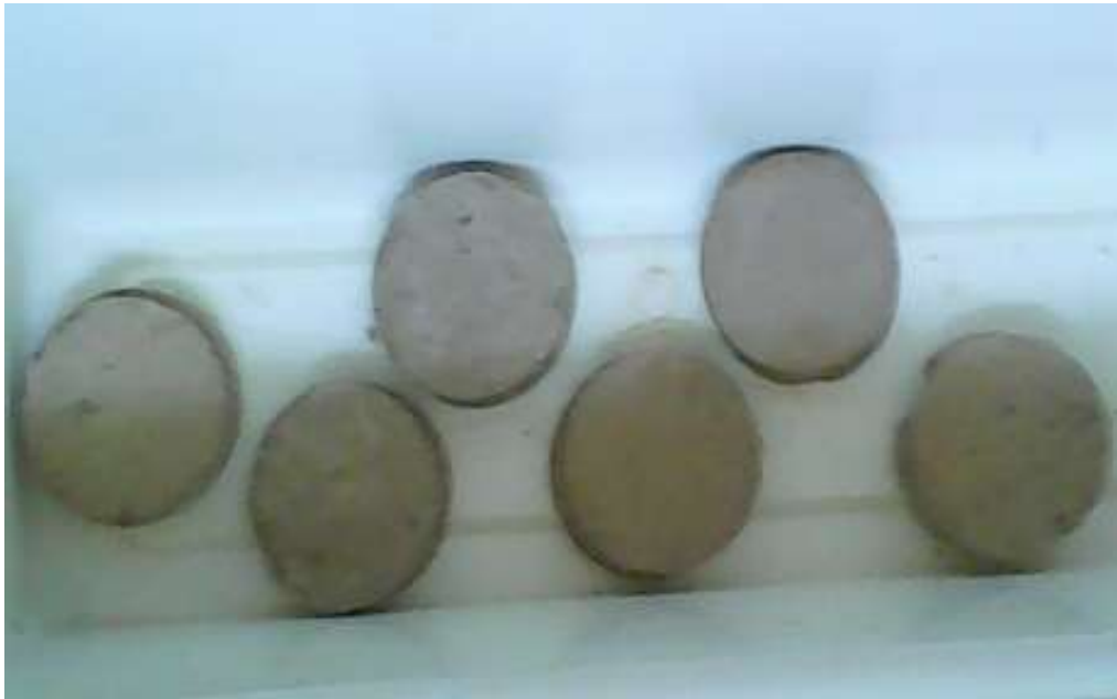
Рис. 2.4. Загальний вигляд ґрунтових зразків після завершення випробувань (п'ятнадцять циклів нагріву-охолодження)
