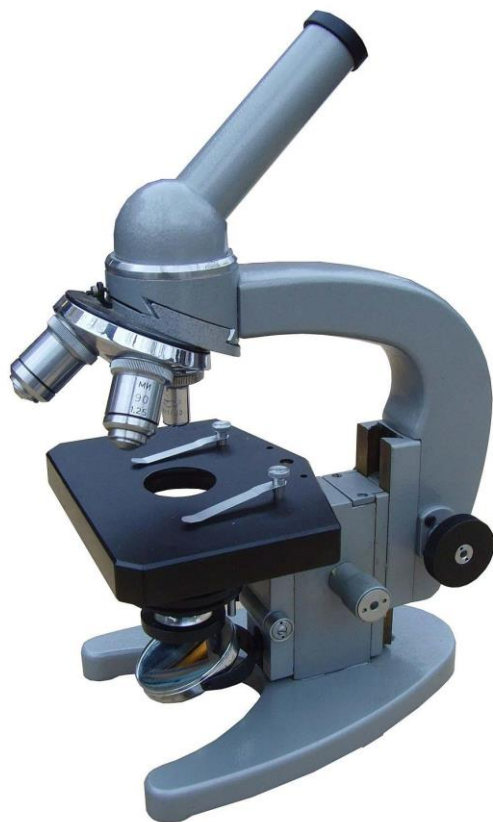
Рис. 1.2. Зовнішній вигляд світлових мікроскопів: А – МБР-1; Б – «Біолам»
