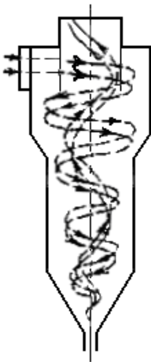
Рис. 3.19. Осадження аерозолів у відцентровому полі
