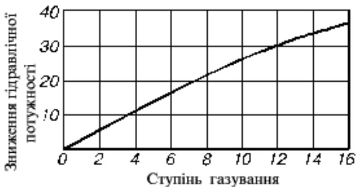
Рис. 10.15. Залежність гідравлічної потужності насоса від ступеня газування бурового розчину
