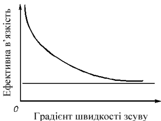
Рис. 4.4. Залежність ефективної в'язкості від градієнта швидкості зсуву
