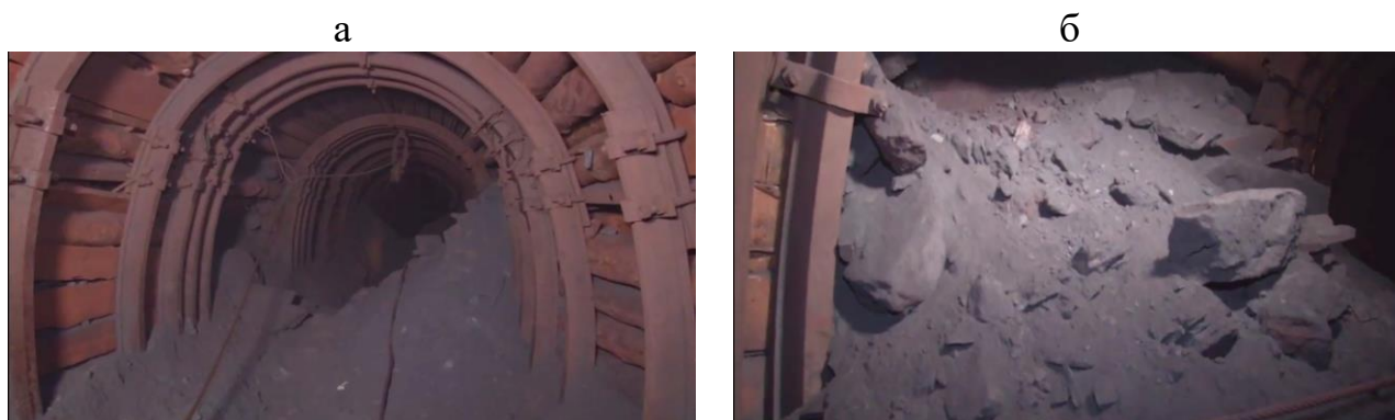
Рисунок 5.1 – Фотофіксація у штреку скреперування (а) та дучці (б) результатів подрібнення руди після відбивання масиву за допомогою наливної ЕВР Україніт-ПП-2 при відпрацюванні запасів експериментального блока
