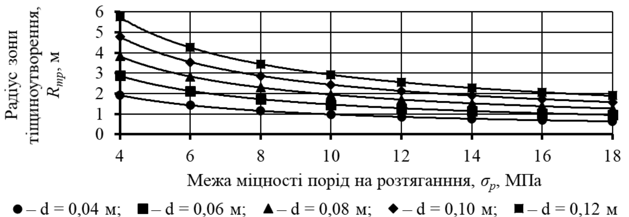
Рисунок 2.8 – Графіки залежності радіуса зони тріщиноутворення від міцності порід на розтягання та діаметра зарядної порожнини при тиску продуктів вибуху 1000 МПа (а), 1500 МПа (б) і 2000 МПа (в)
