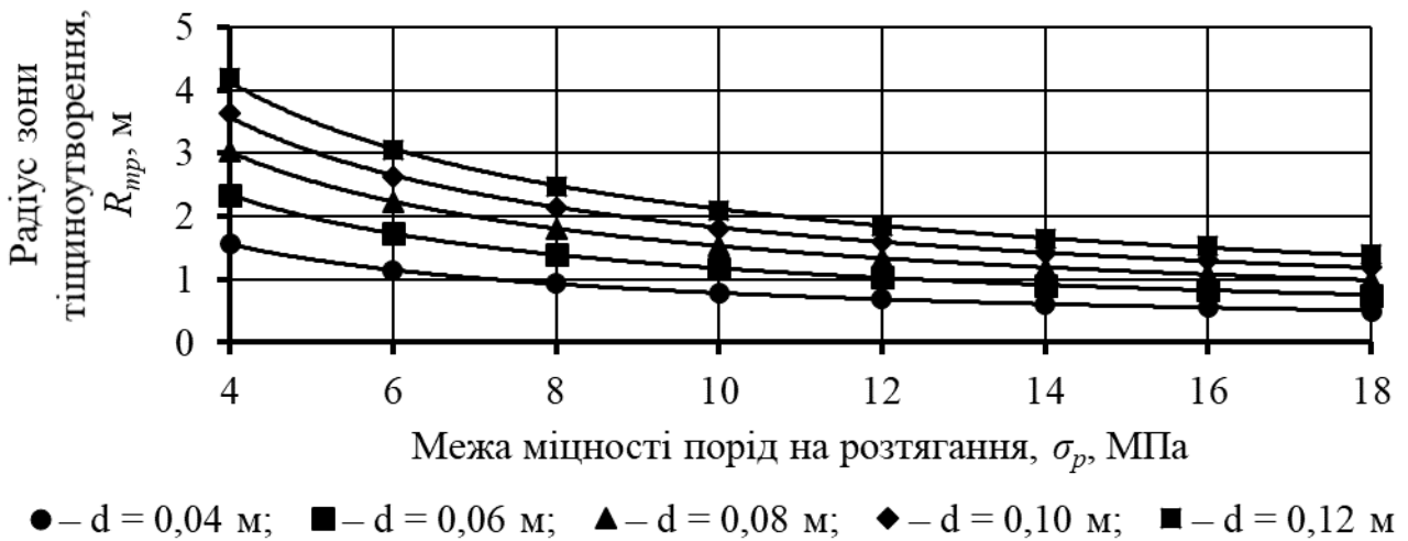
Рисунок 2.18 – Графіки залежності радіуса зони тріщиноутворення від межі міцності порід на розтягання та діаметра зарядної порожнини при тиску продуктів вибуху 1500 МПа
