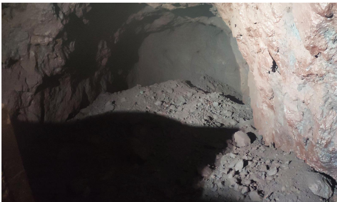
Рисунок 4.5 – Фотофіксація вибою орту горизонту 910 м до вибуху (а) та після вибуху (б) за розрахованими параметрами БПР в умовах ПрАТ «ЗЗРК»
