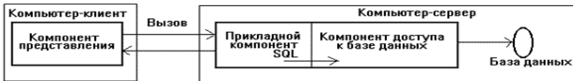
Рис. 6.17. Модель клієнт/серверної архітектури з сервером баз даних
