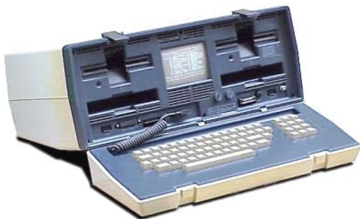
Рис. 8. Самий перший переносний персональний комп'ютер, створений у 1981 р. у вигляді чемодану, який випускала фірма Osborne Computers (США). Вага у зібраному вигляді 10 кг.
