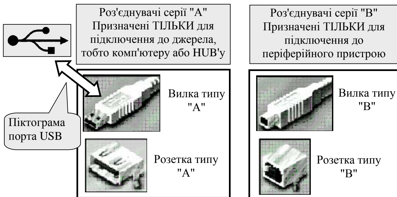
Рис. 4.20. Піктограма позначення і роз'єми (вилки и розетки) послідовного порта USB
