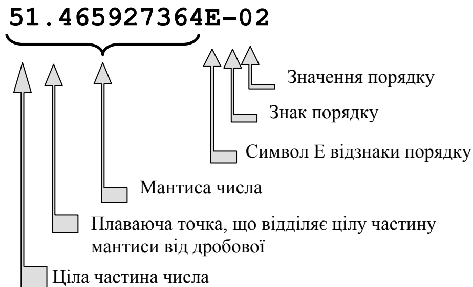
Рис. 8.28. Складові частини числа дійсного типу з плаваючою точкою (так звана експоненціальна або логарифмічна форма запису)
