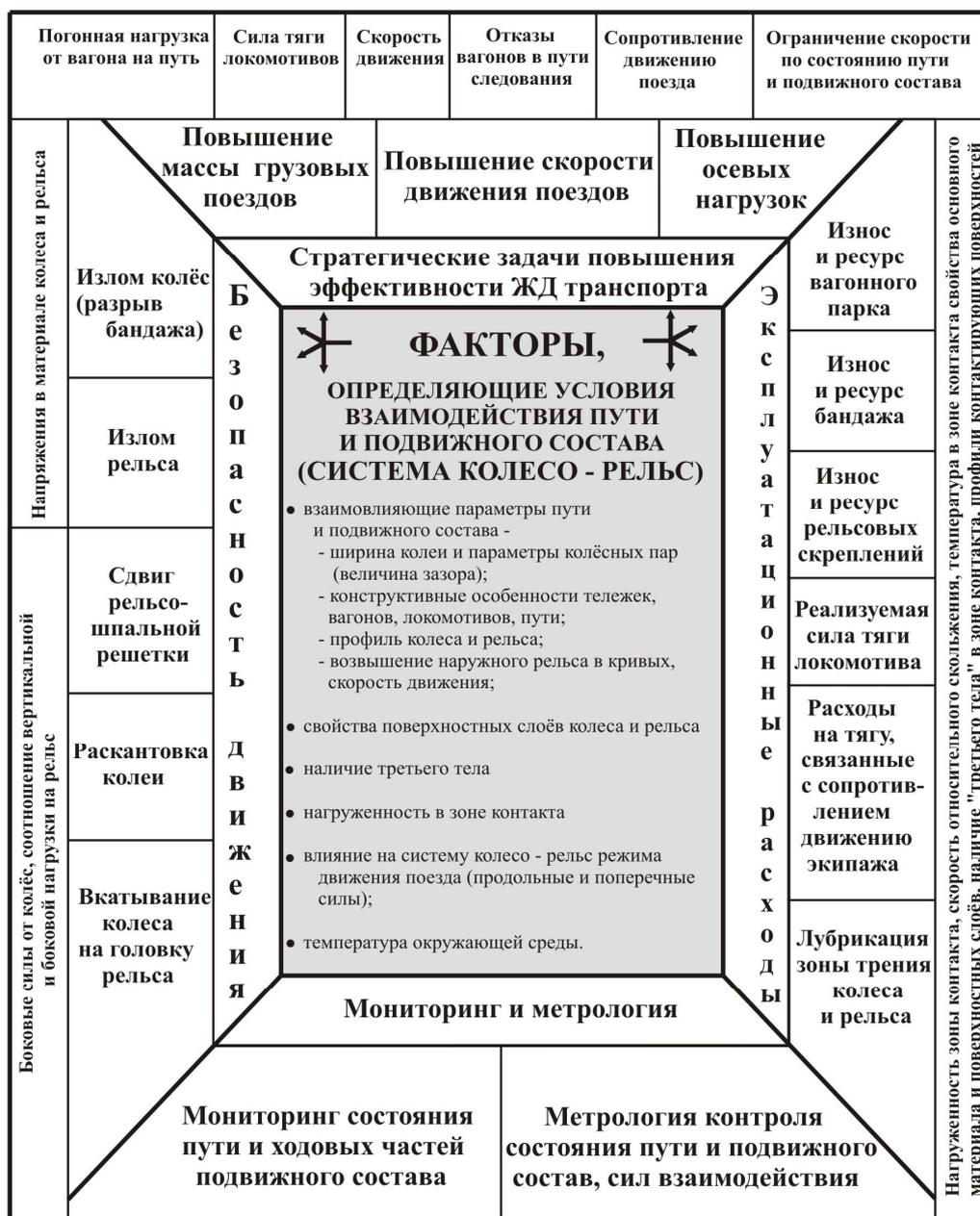
Рисунок 1.5 – Факторы, влияющие на взаимодействие колеса и рельса
