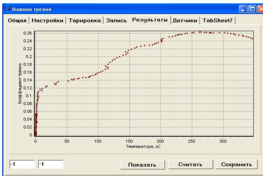
Рисунок 5.14 – Программа «FrictionMachine» (закладка «Результаты»)
