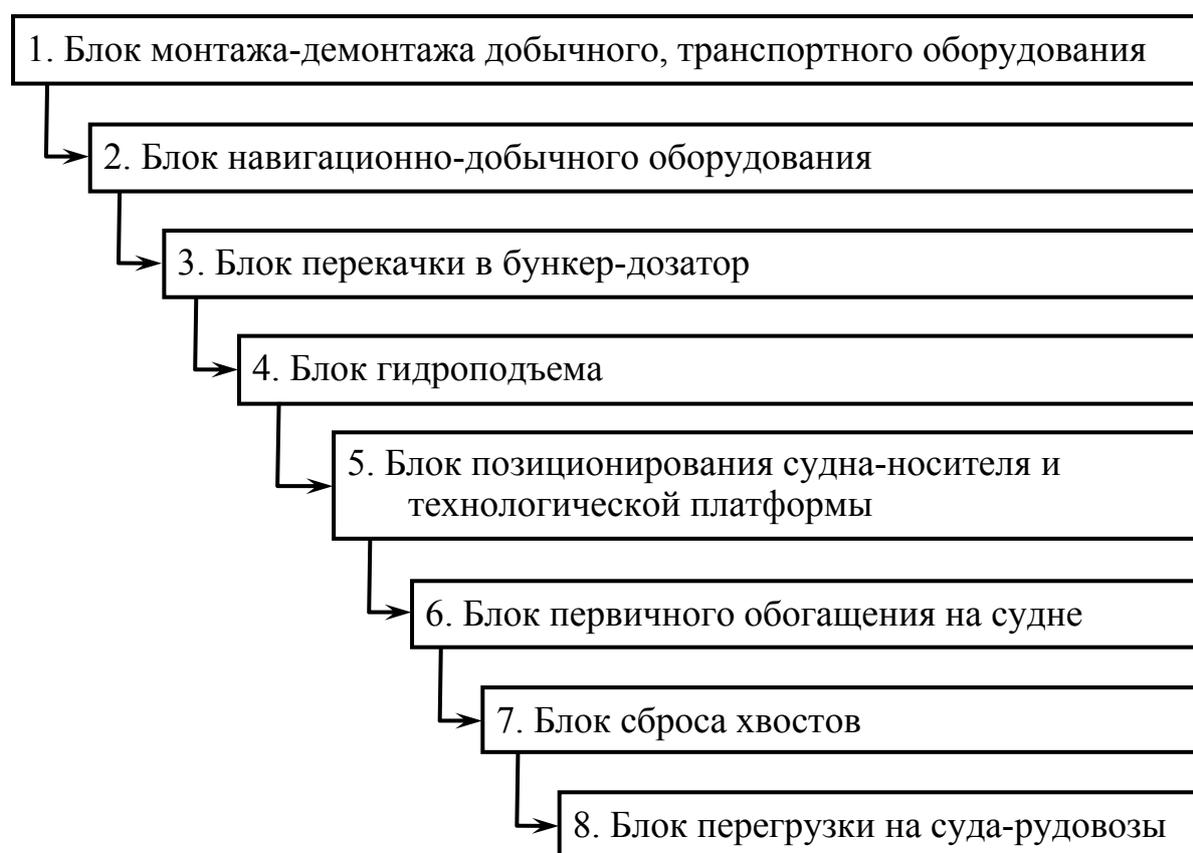
Рисунок 4.1 – Согласование технологических звеньев морского горнодобывающего комплекса
