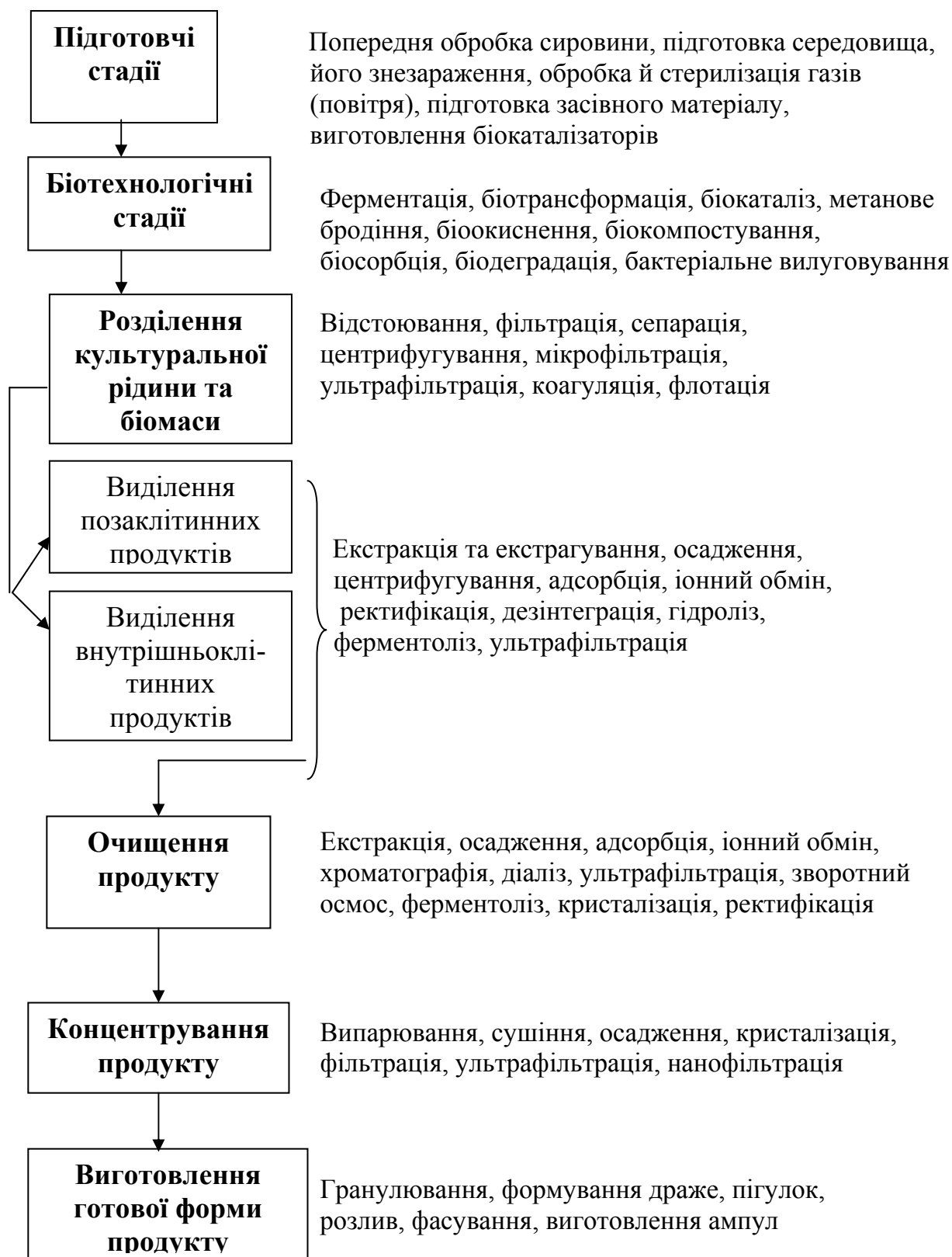
Рис. 2. Узагальнена схема стадій біотехнологічного виробництва
