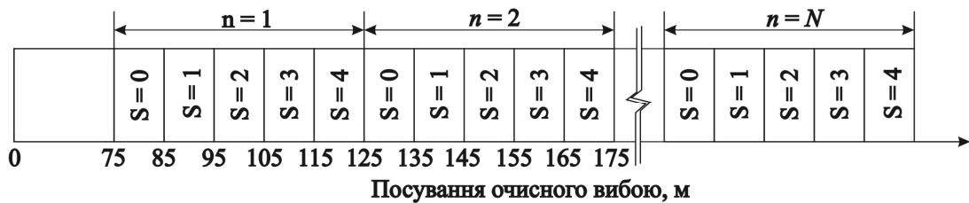
Рис. 5. Періодичність прояву гірського тиску за довжиною виїмкового стовпа
