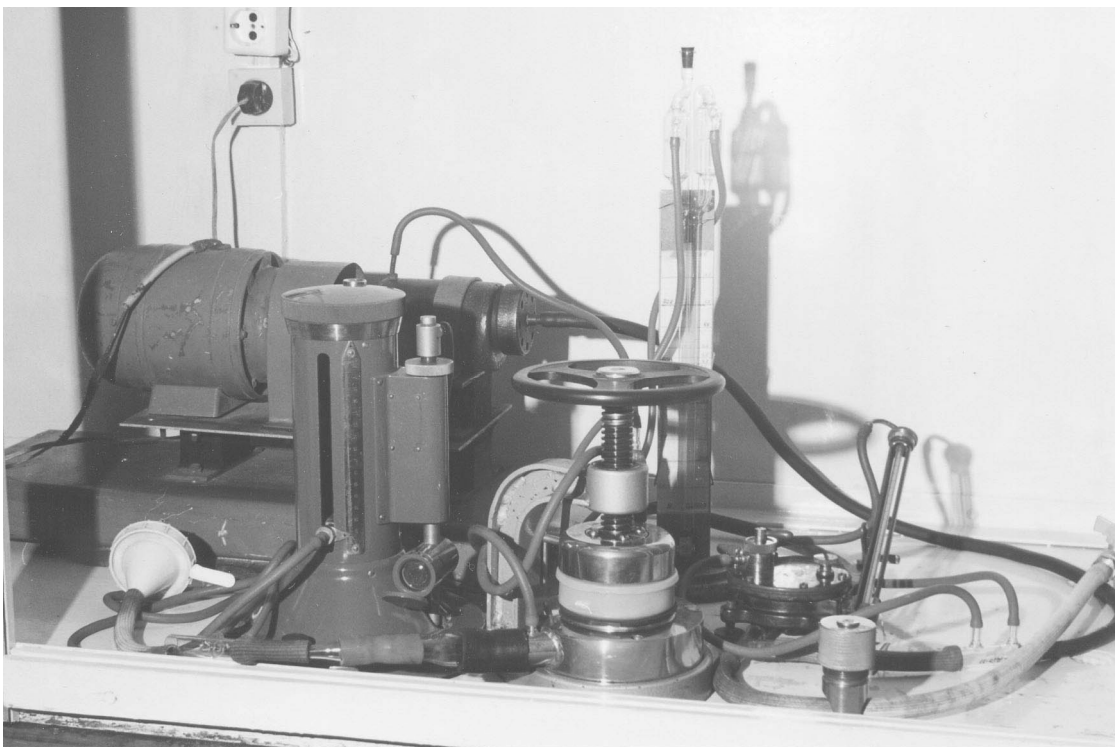
Рисунок 2.4 – Зовнішній вигляд установки для дослідження пилоємності фільтрів і фільтруючих матеріалів (згаданий спеціальний затиск – в центрі на передньому плані).
