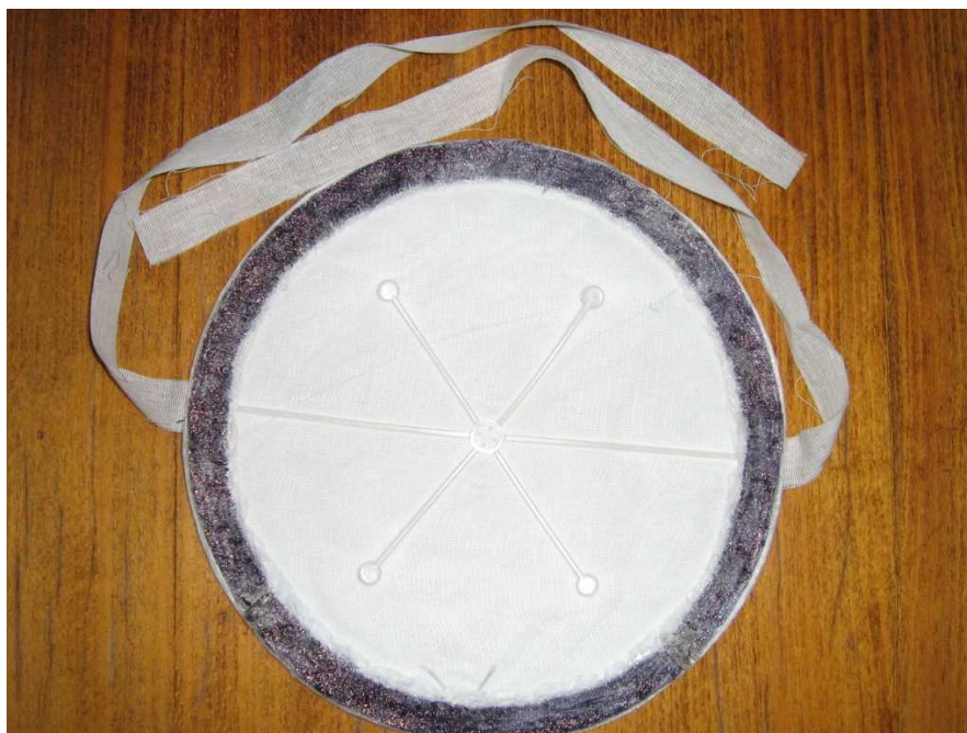
Рисунок 8.16 – Респиратор «Лепесток» з додатковою смужкою з триплексу
