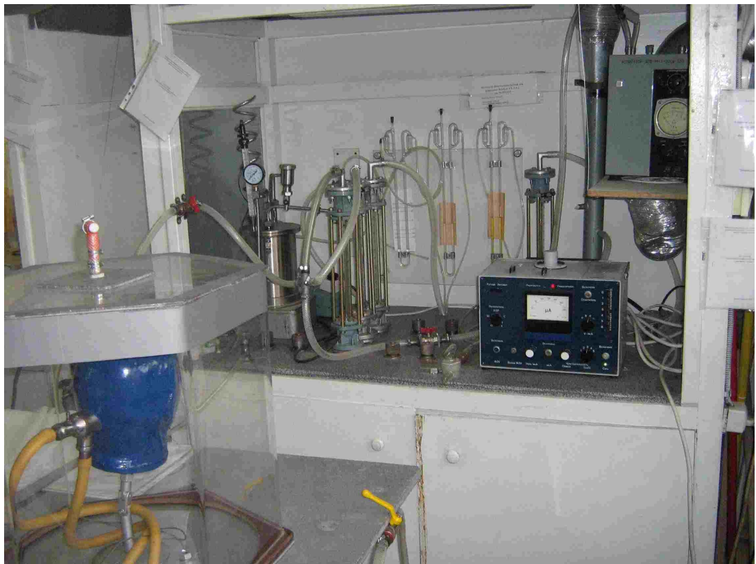
Рисунок 8.14 – Загальний вигляд установки для випробувань ЗІЗОД на парафіновому маслі
