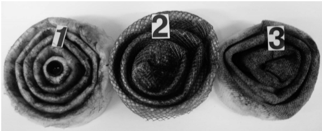
Рисунок 1.12 – Фільтри до респіратору Астра: 1 – з матеріалу елефлен; 2 – з ФПП 15-1,5 з капроною сіткою в основі; 3 – з ФПП 15-1,5 з основою – марля апретирована.
