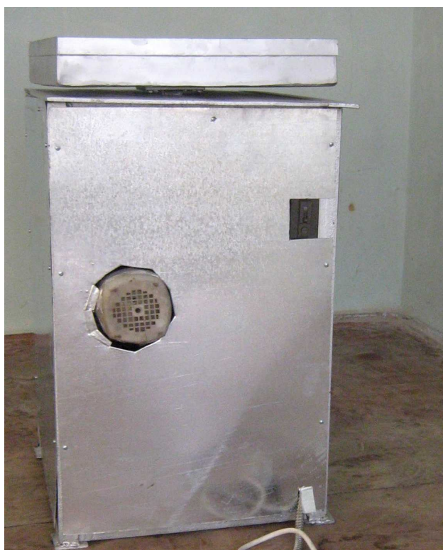
Рисунок 8.7 – Установка для випробувань на механічну міцність ЗІЗОД і фільтрів
