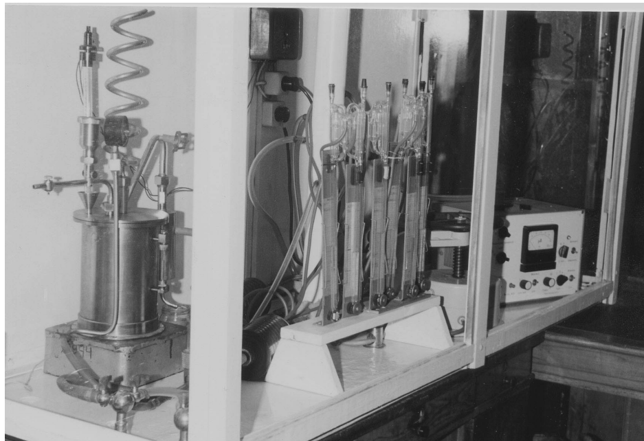
Рисунок 2.2 – Загальний вигляд установки по визначенню захисної ефективності фільтруючих матеріалів і фільтрів
