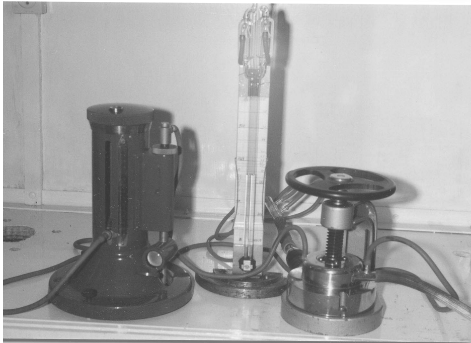
Рисунок 2.3 – Зовнішній вигляд установки для виміру опору фільтруючих матеріалів і фільтрів
