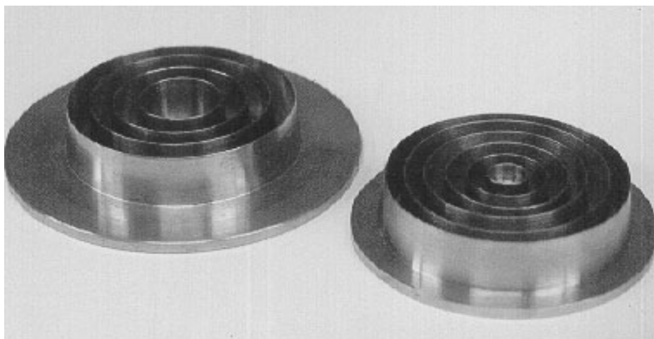
Рисунок 6.1 – Матриці для формування гофрованих фільтрів з конусних заготовок
