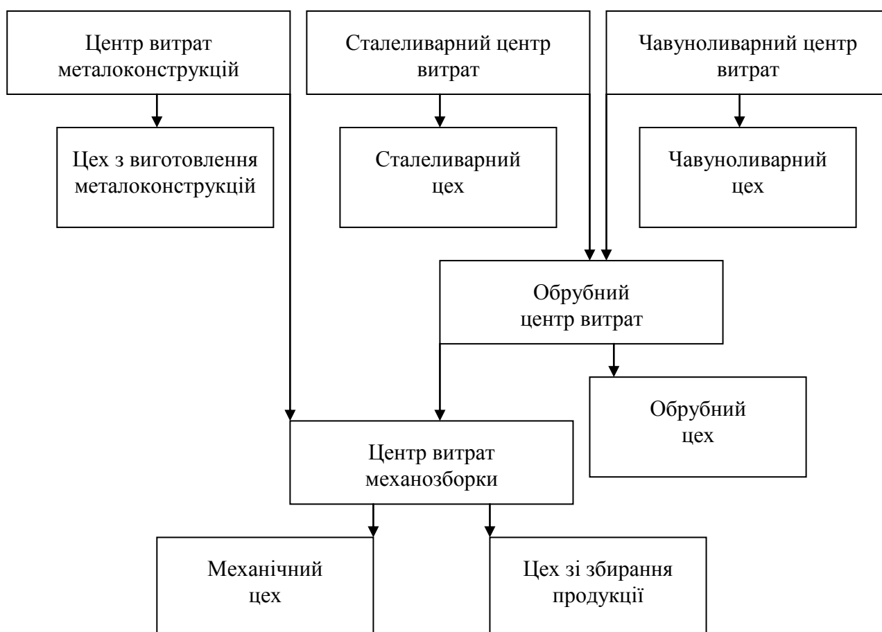
Рис. 3.4. Технологічний цикл виробництва ПАТ «ДНІПРОВАЖМАШ»
