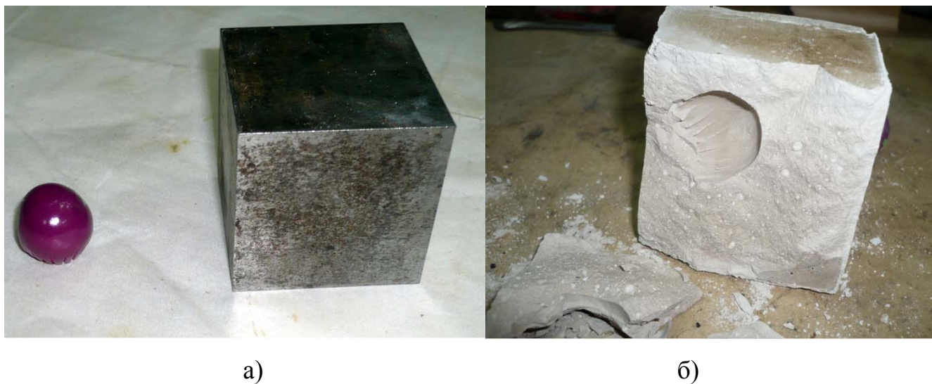
Рисунок 3.9 – Общий вид образца НРС с пластиковым шаром:
