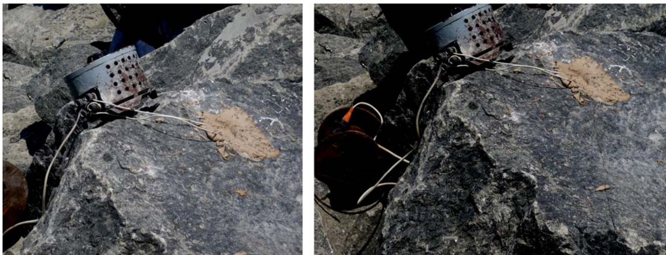
Рисунок 6.4 – Разрушение гранитного блока при пропускании через НРС электрического тока
