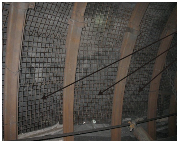
Рис. 2.62. Места отсутствия полной комплектации рам арочной крепи
