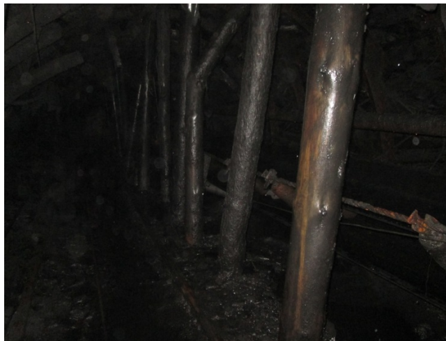
Рис. 2.42. Обводненный участок выработки
