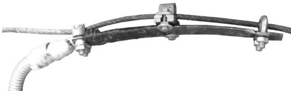
Рисунок 3.15 – Тензорезисторный датчик усилия натяжения каната конструкции НГУ
