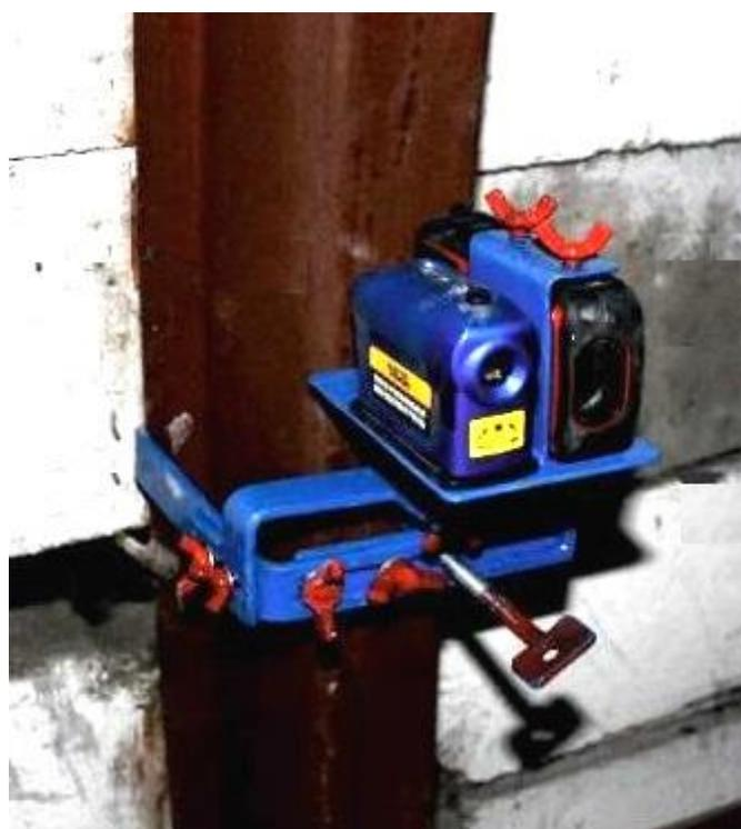
Рис. 3. Установка устройства на стойке металлической крепи
