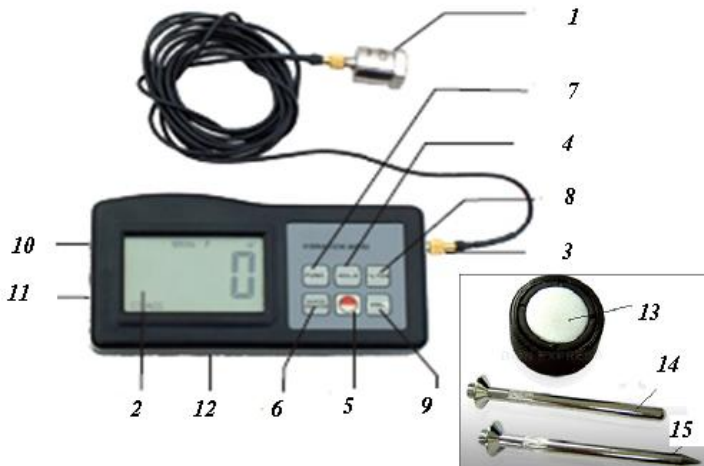
Рис. 1. Віброметр VM 6360: 1 – акселерометр, 2 – дисплей, 13 – магнітний датчик, 14 – кульовий зондовий датчик, 15 – конусний зондовий датчик
