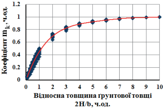
Рис. 6. Залежність відносних осідань круглого (а) і квадратного (б) фундаменту від відносної товщини ґрунтового шару
