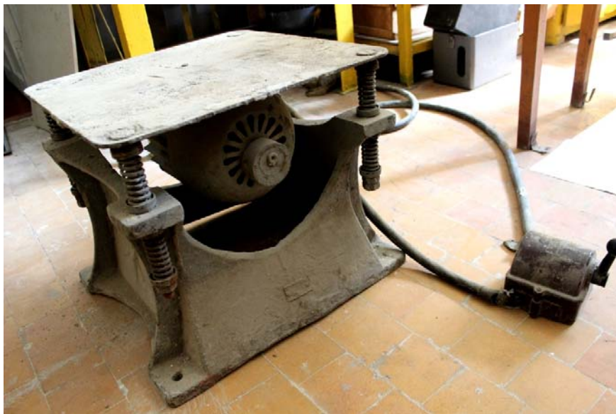
Рис. 2.13. Вибростол для уплотнения бетонной смеси
