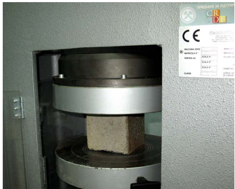
Рис. 2.8. Испытание бетонного образца на одноосное сжатие
