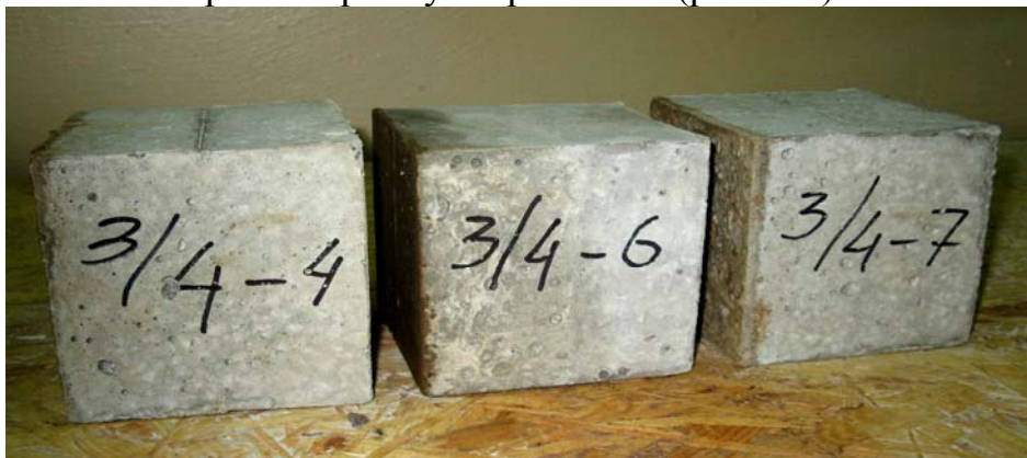
Рис. 2.5. Образцы-кубы для испытания на сжатие
