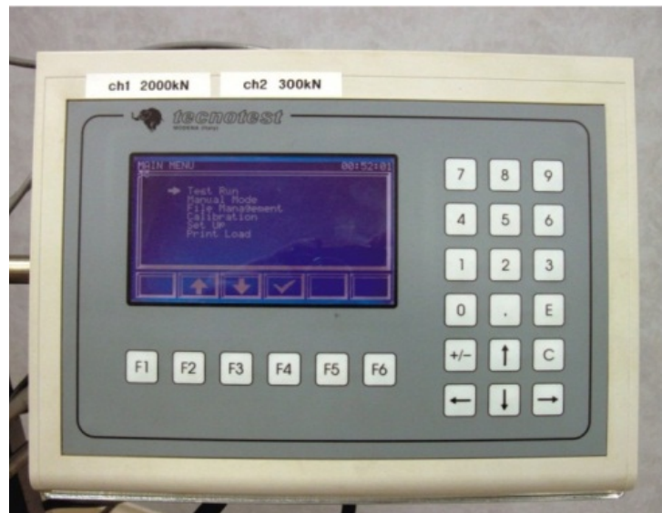
Рис. 2.9. Блок управления испытательной машины
