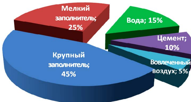
Рис. 2.1. Соотношение между компонентами в бетонной смеси
