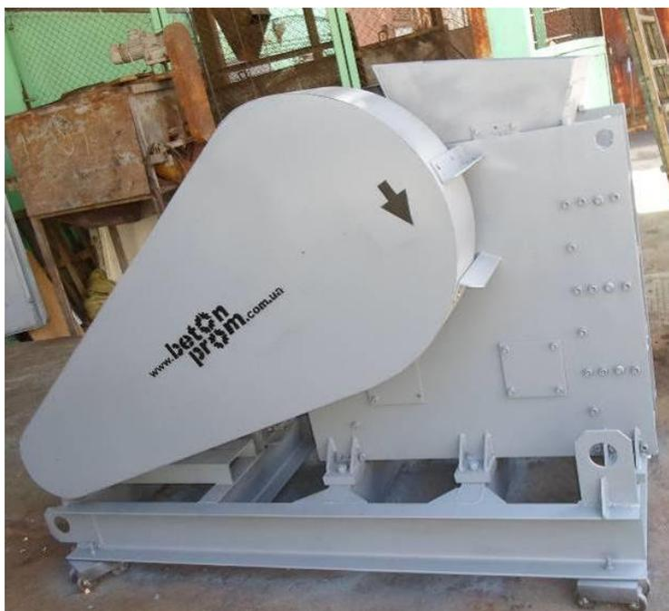
Рис. 2. Дробилка щекового типа ДЩ-350-400
