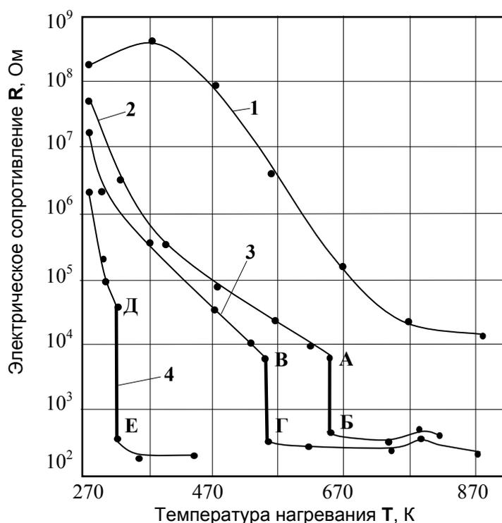
Рис. 3. Изменение электрического сопротивления яшмы от температуры при постоянном значении напряженности внешнего электрического поля ( $E_3=300$  В/см) [5]: 1 – простой нагрев; 2, 3, 4 – соответственно первая, вторая и третья термоэлектрическая обработка; А-Б, В-Г и Д-Е – участки кривых, соответствующие скачку сопротивления
