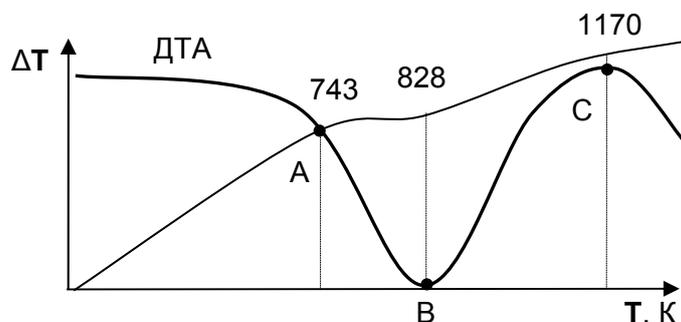
Рис. 2. Кривая дифференциального термического анализа сидерита
