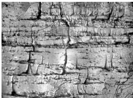
Рис. 2 –Типичный вид полостной структуры, формирующейся при погружении угольных пластов.
