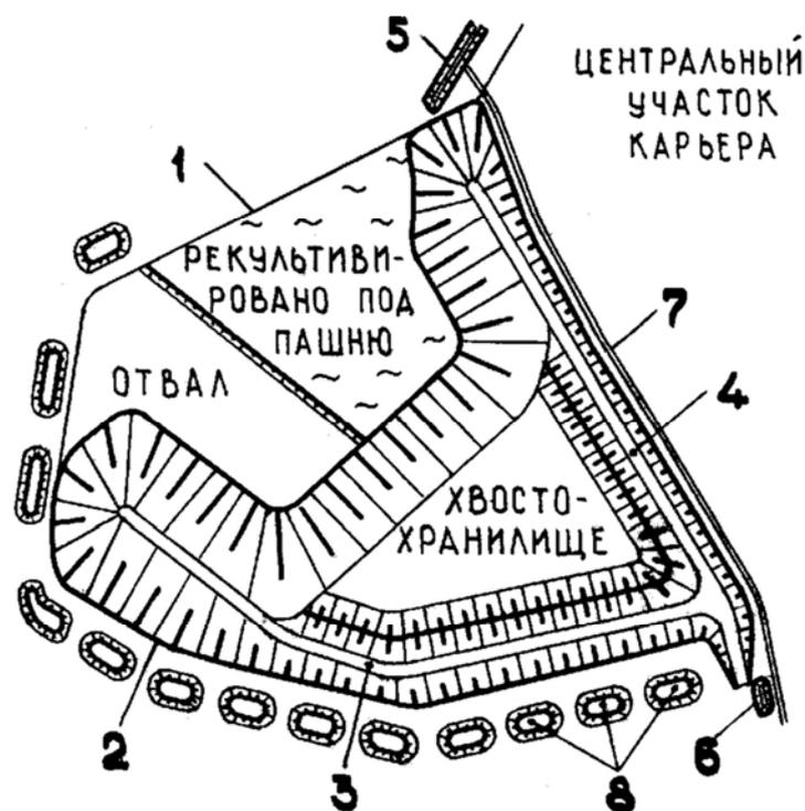
Рис. 2. Схема размещения отходов горного производства южного участка Мотроновского карьера: 1,2 – контуры карьерного поля по руде и вскрыше; 3,4 – положение разрезной траншеи по восточной границе карьерного поля и по б. Дмитровская; 5,7 – головная и защитная дренажные траншеи с водосборником карьерного водоотлива; 6 – трубопровод водоотлива; 8 – секционные склады снятого чернозема
