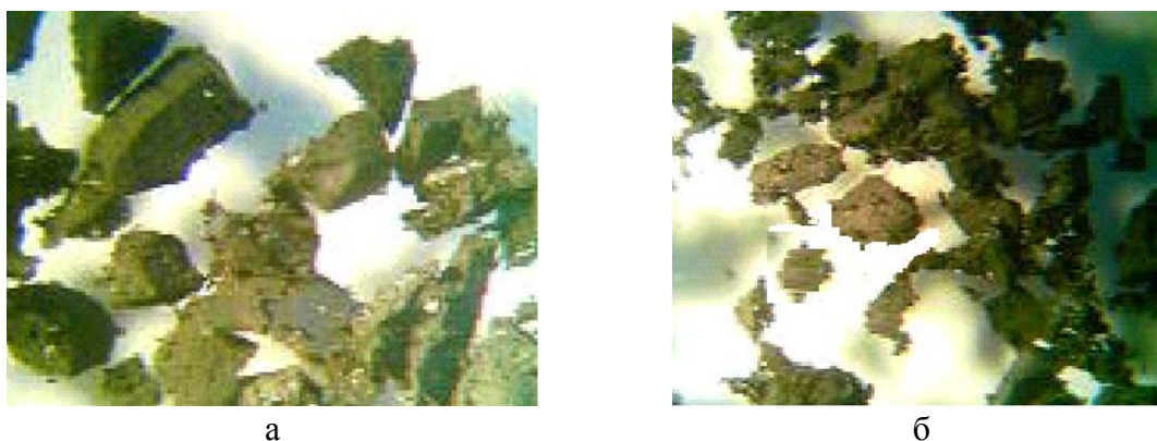
Рис. 2 - Поверхность резиновой крошки (оптический микроскоп МБС-10, х 8): а – неактивированной, б – механоактивированной
