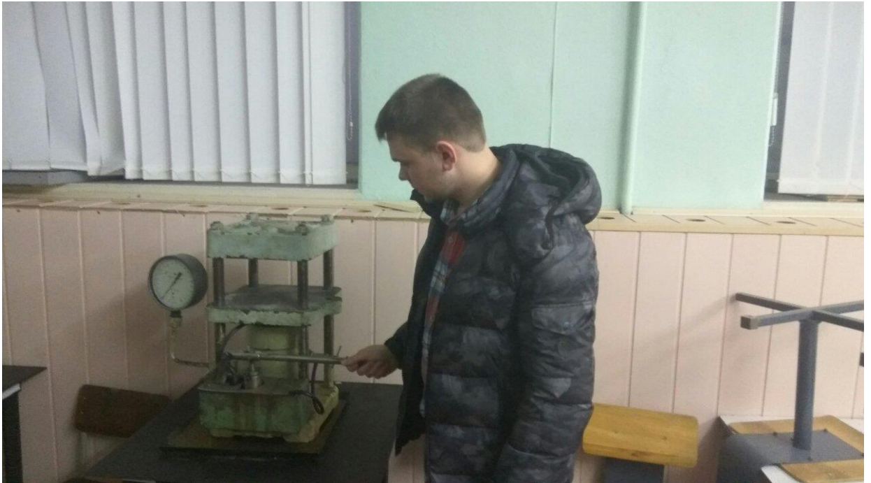
Рис. 3.1.3. Методика визначення міцності цементно – піщаних зразків
