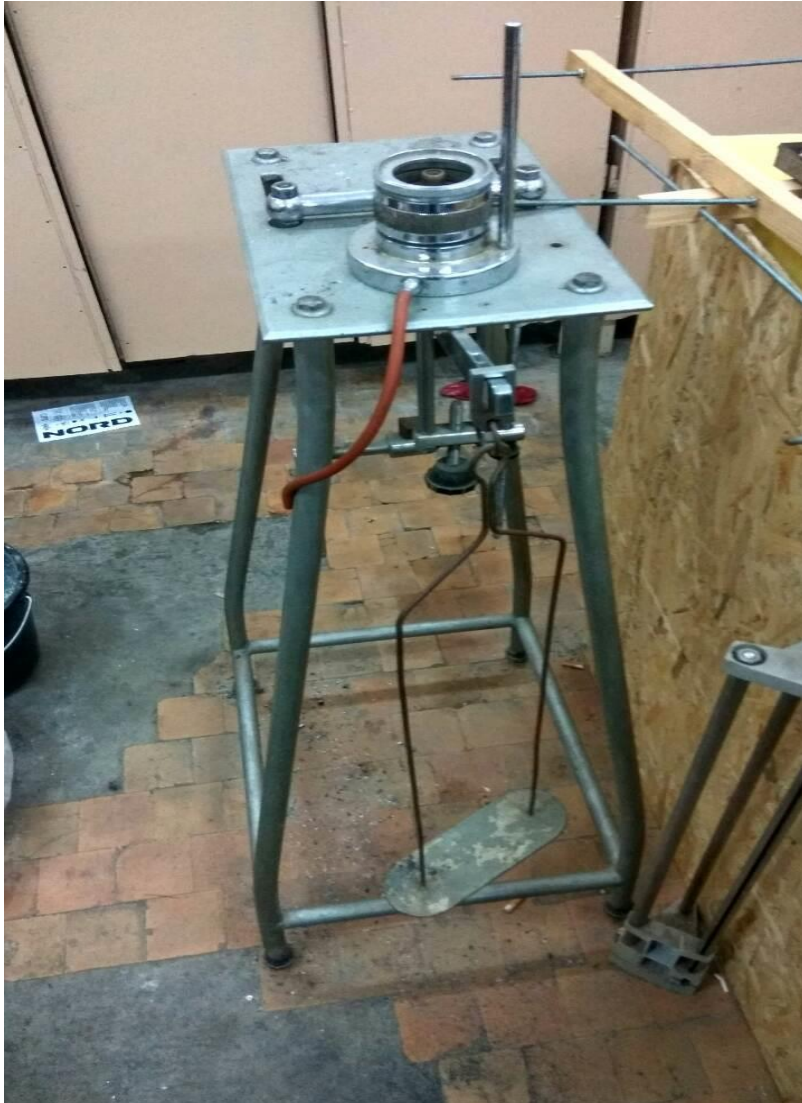
Рис. 3.2.1. Компресійний прилад. Загальний вигляд.
