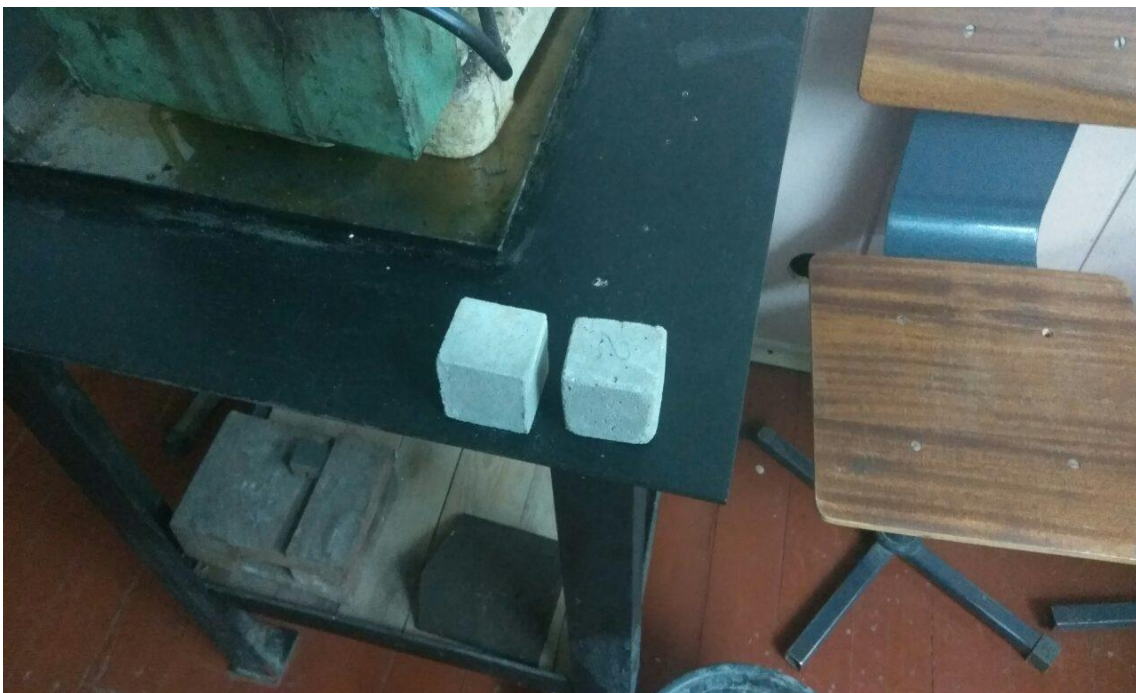
Рис. 3.1.2. Цементно – піщані зразки – кубіки 10x10x10 см.
