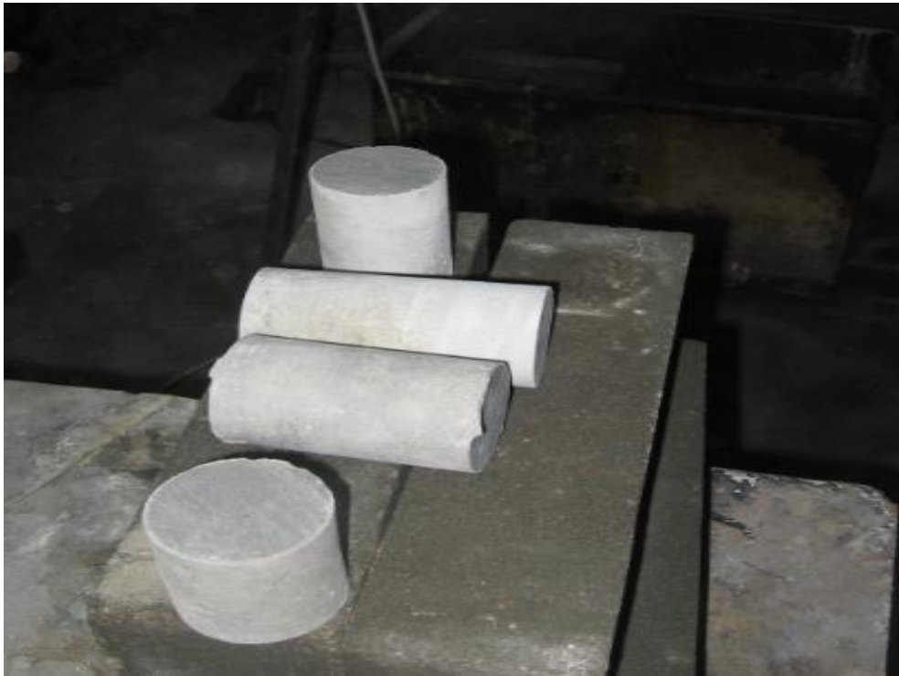
Рис. 3.3.19. Керни, випиляні з ґрунтоцементних елементів після їх випробувань великорозмірними штампами
