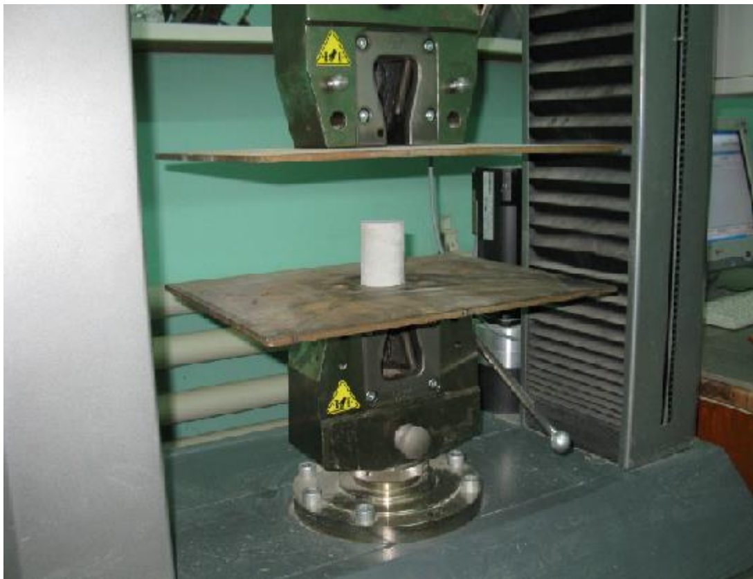
Рис. 3.3.19. Керни, випиляні з ґрунтоцементних елементів після їх випробувань великорозмірними штампами
