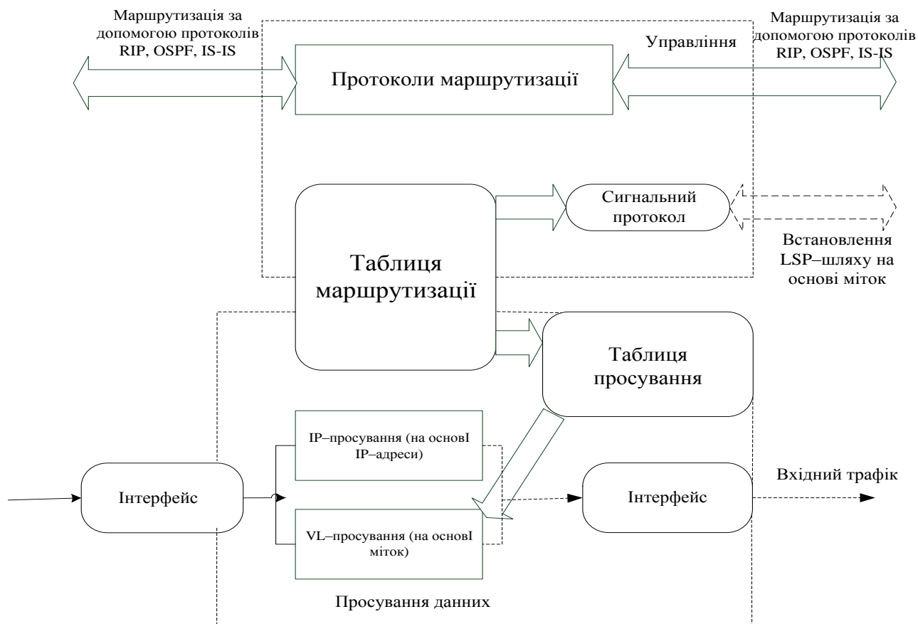
Рисунок 3.14 – Архітектура LER-маршрутизатора (комутатора) і LSR-комутатора
