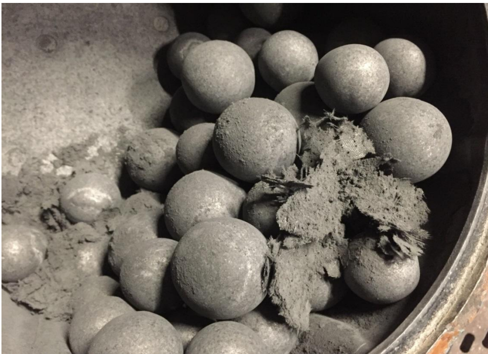
Рис. 3. Зовнішній вигляд піролізованого електронного скрапу після обробки у кульовому млині
