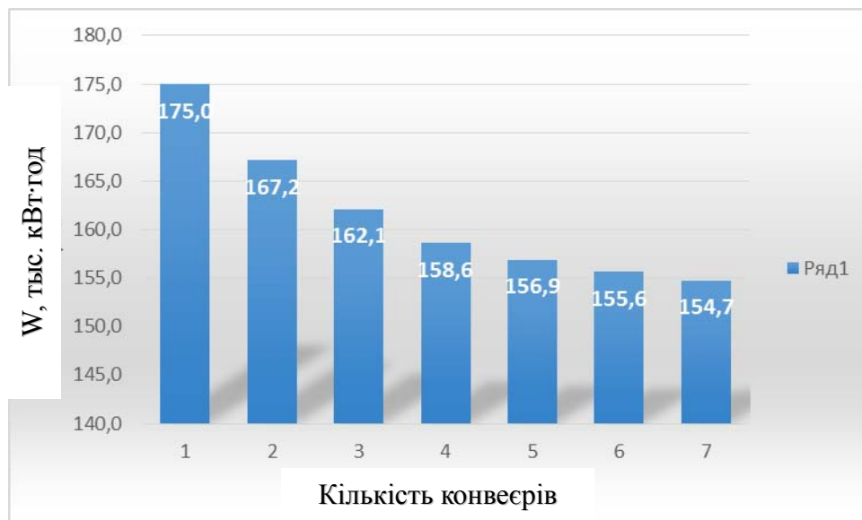
Рис. 4.17. Діаграма зміни величини річного електроспоживання ділянки конвеєрного транспорту з використанням перетворювачів частоти залежно від кількості конвеєрів у лінії довжиною 1 км
