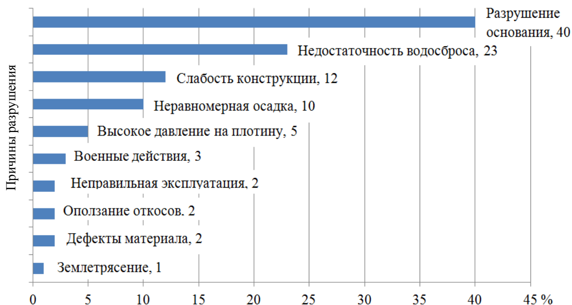
Рис. 2. Основные причины разрушения грунтовых плотин (по данным [1, 2])
