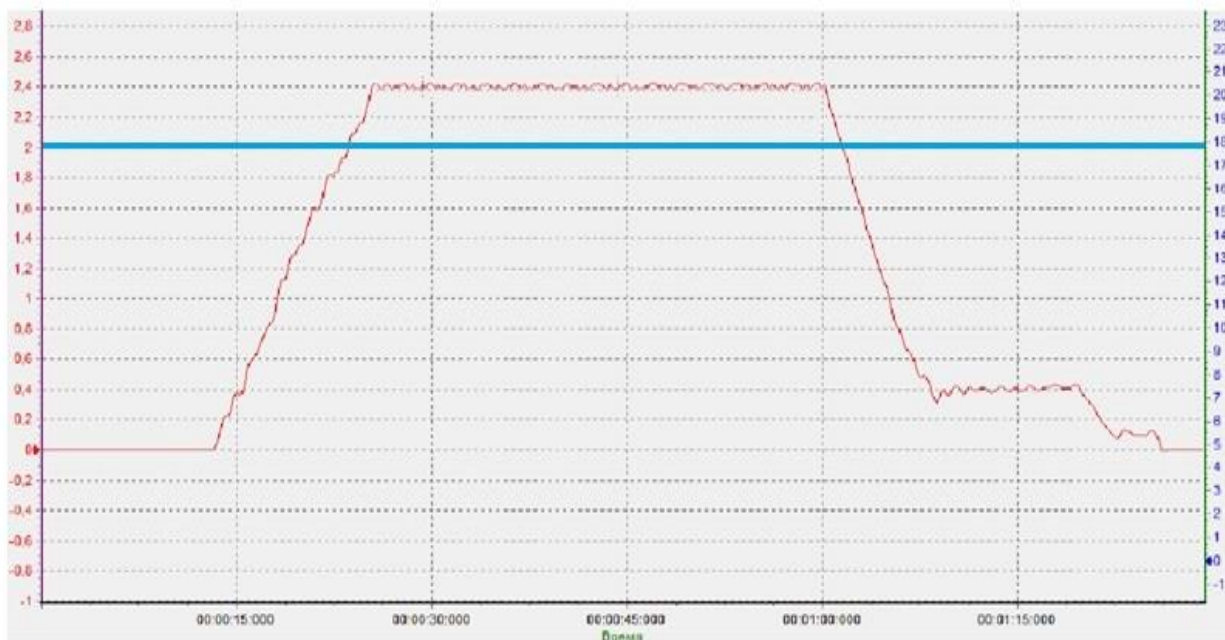
Рис. 5. Пример диаграммы движения «Вперед» нештатного состояния ШПУ. (где жирная полоса, нормальная скорость ШПУ)
