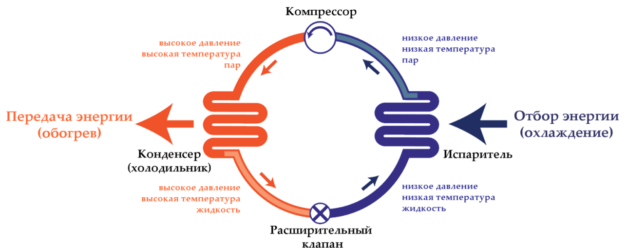
Рисунок 1.1 Схема теплового насоса.
