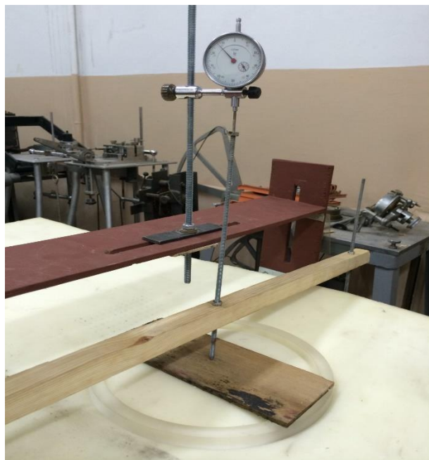
Рис. 2.1.3. Загальний вигляд верхньої частини лотка для випробування моделей фундаментів на поліуретановій основі
