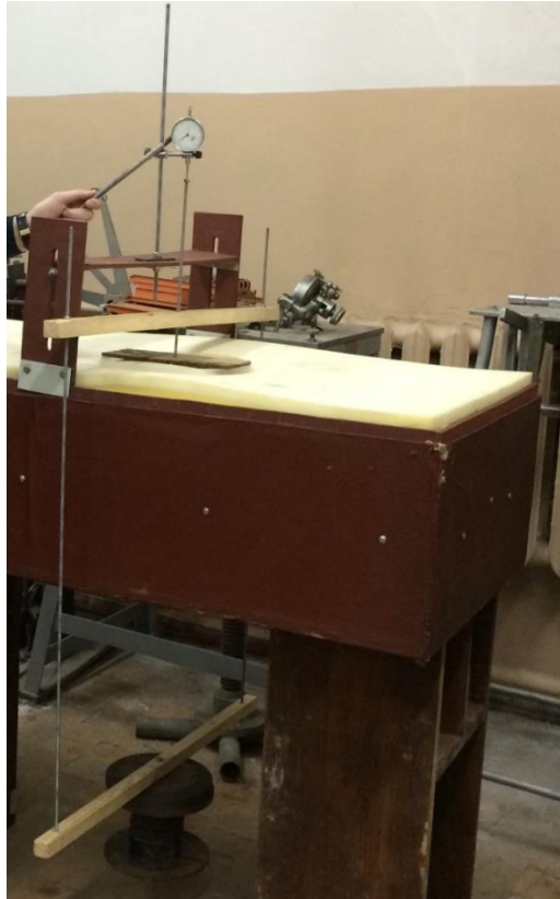
Рис. 2.1.2. Загальний вигляд установки для лоткових випробувань моделей фундаментів (штампів) на модельному матеріалі (поролон)
