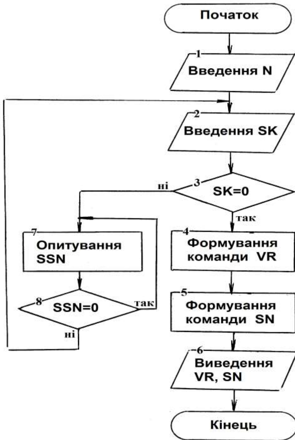
Рисунок 2.2 – Блок схема алгоритму функціонування блоку формування сигналу номеру станції
