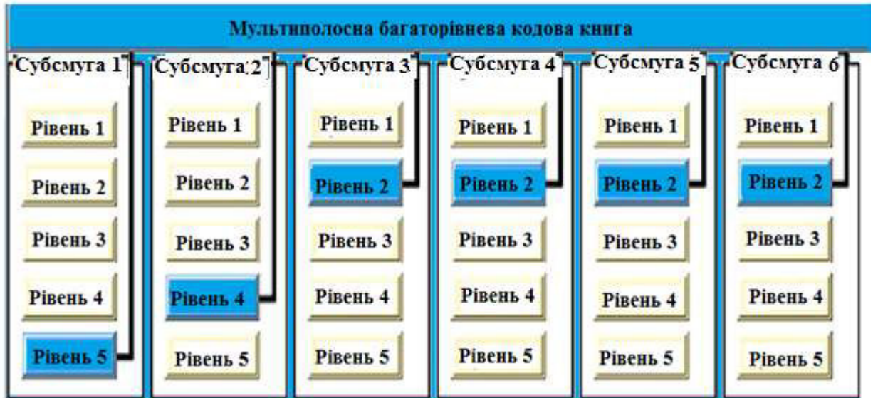
Рисунок 2.25 – Структура мультисмугової багаторівневої кодової книги
