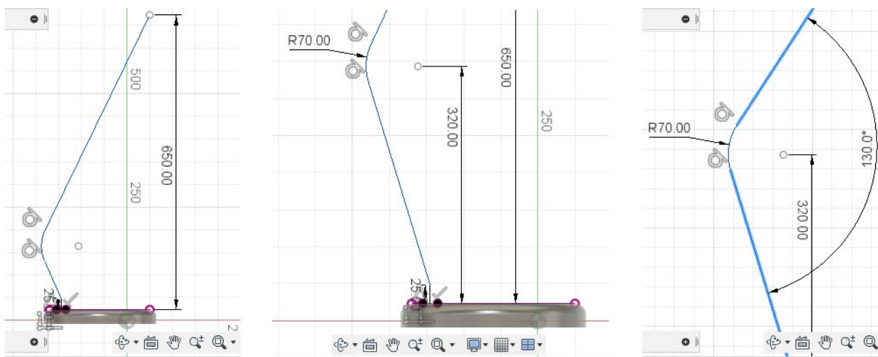
Рис. 66. Встановлення розмірів в різних частинах лампи
