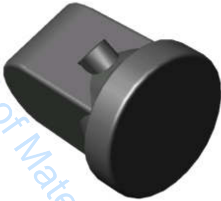
Малюнок 2.1. 3D модель базового варіанту заготовки деталі «Головка»
