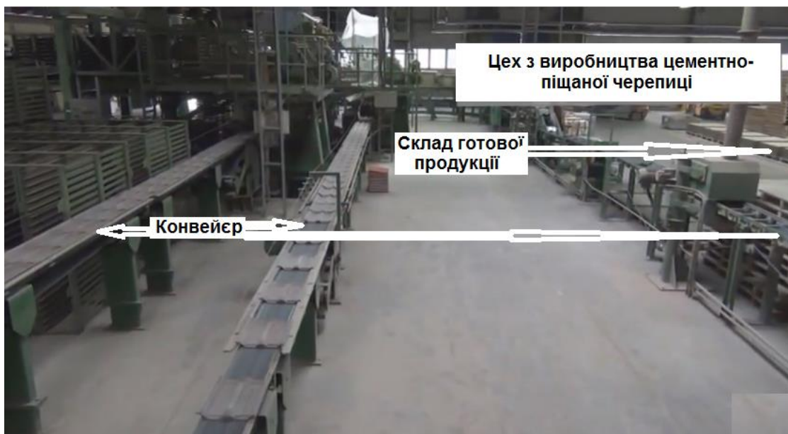
Рисунок 3 - Конвеєр, призначений для виробництва цементно-піщаної черепиці
