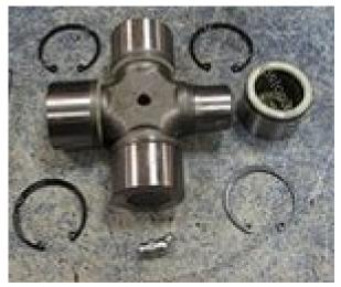
Типовая конструкция подшипника карданного представляет собой четыре подшипника, внутренние втулки которых образуют единую крестовину, четыре обойм, плотно установленных в вилках карданного вала, промежуточные тела качения в виде роликов малого диаметра, уплотнения зоны трения подшипников, стопорные кольца и тавотницу [5]. Тавотницы могут распола-
