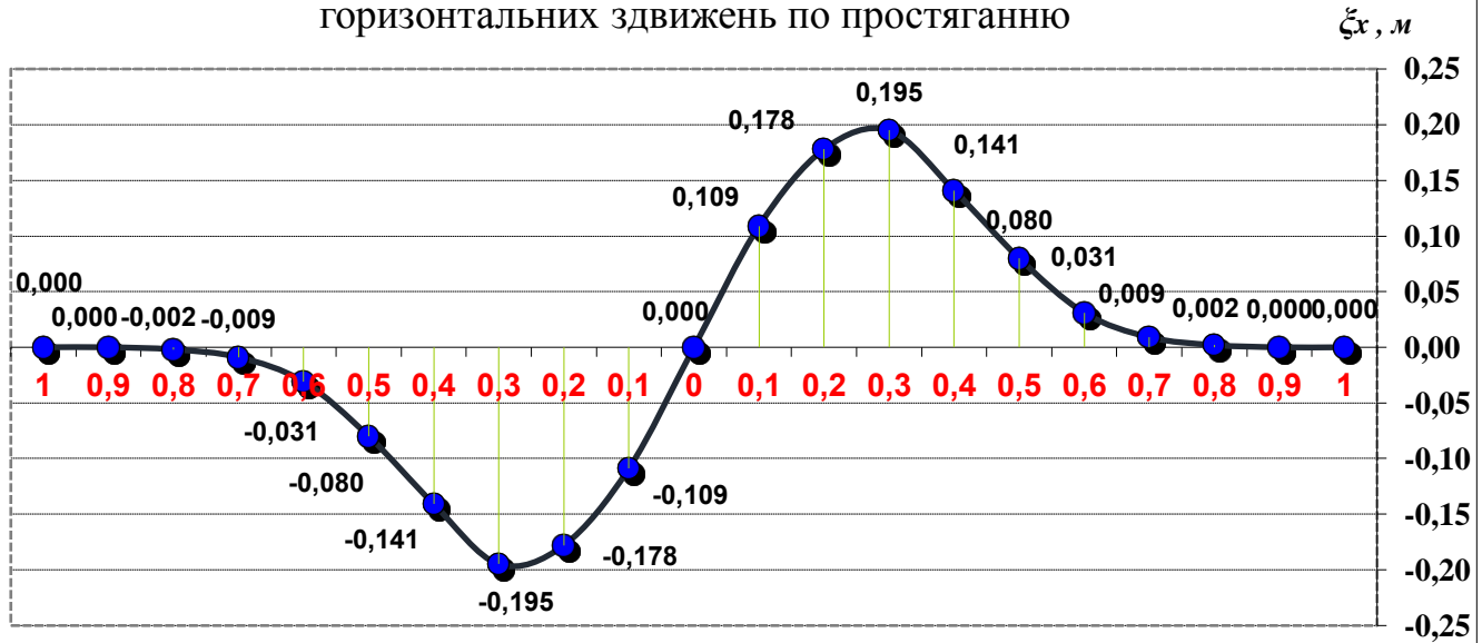
Рис. 4.6 Графік очікуваних горизонтальних зрушень по простяганню
