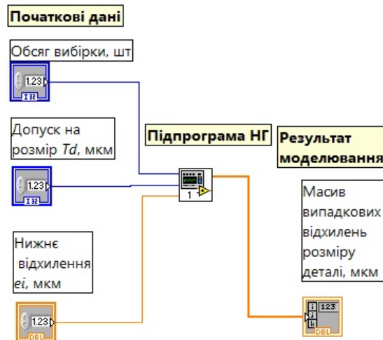
Рисунок 3 – Програмний код у вигляді підпрограми для розмірів деталі класу НГ
