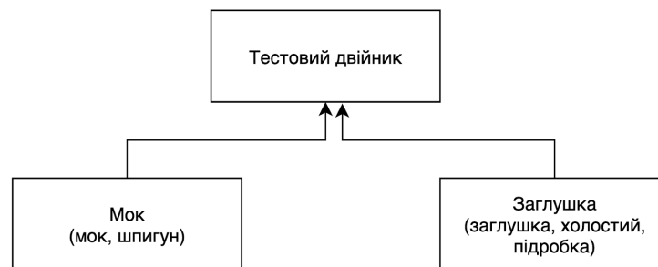
Рис. 2.2. Поділення тестових двійників на мок та заглушки
