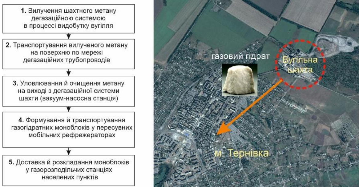
Рис. 1. Алгоритм виконання технологічних процесів із забезпечення населених пунктів альтернативним газом із газових гідратів
