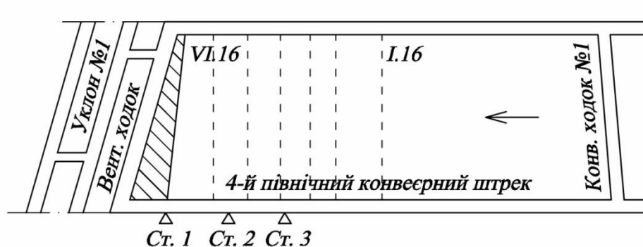
Рис. 3.1. Розташування вимірювальної станції у 4-му північному конвеєрному штреку пласта m_4^2
