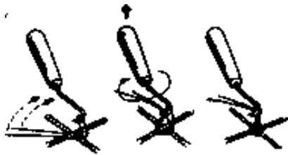
Рисунок 3.3 – Перев'язка арматури дротяними скручуваннями за допомогою спеціальних крюків
