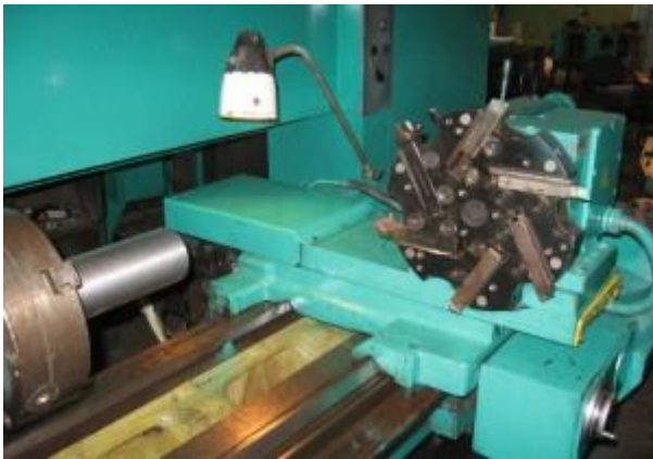
Рис. 2.2. Револьверна головка верстата
