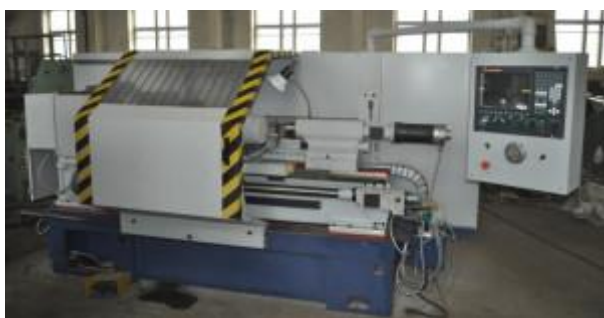
Рис. 2.1. Загальний вид верстата 16К20Ф3
