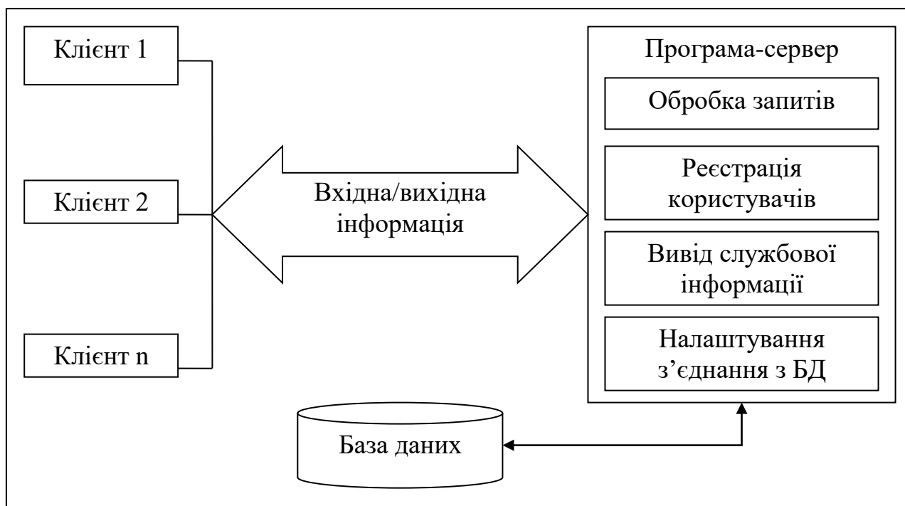
Рис. 2.4. Організація руху інформації (вхід/вихід) в серверній частині системи
